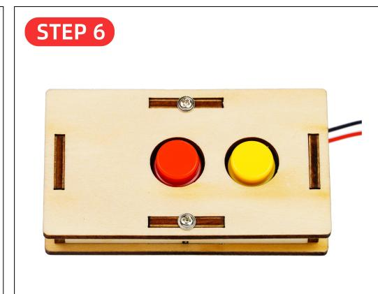
用M2\*4螺丝将正面外壳固定到侧面外壳上。
