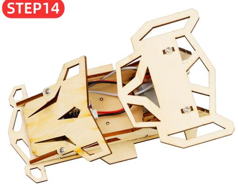
用M2\*6螺丝将前盖与尾翼固定到侧板上。
