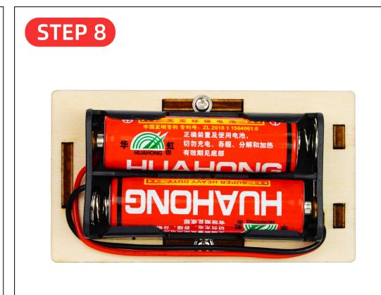
2 安装两节5号电池，不使用时应取出电池，避免电池电量耗尽。
