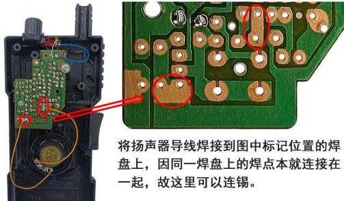
将扬声器导线焊接到图中标记位置的焊盘上，因同一焊盘上的焊点本就连接在一起，故这里可以连锡。
